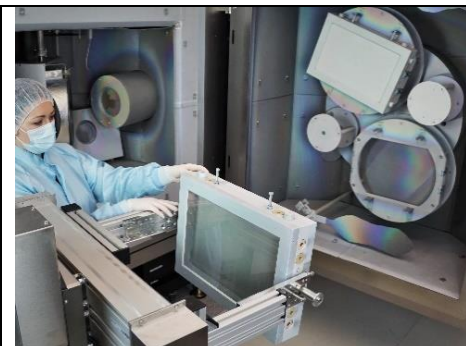
Abb. 1 Einbau eines (450 x 300 x 80) mm Substrates in die IBS-Anlage.
