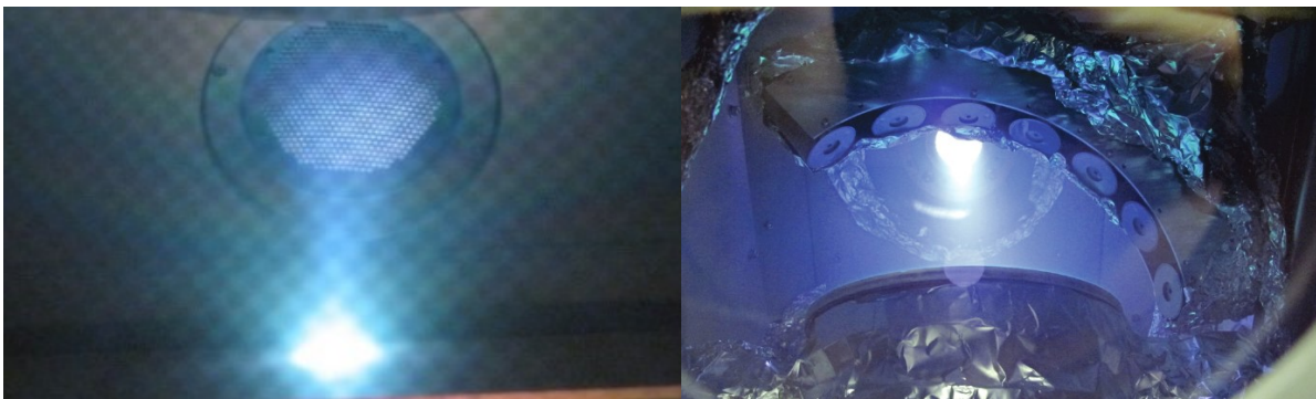
Abbildung 1: Aufnahme des Prozessraumes im Ion Beam Sputtering Prozess. Links - Produktionsprozess am Sputtertarget. Rechts - IBS Prozess mit GFA Sensorik.
