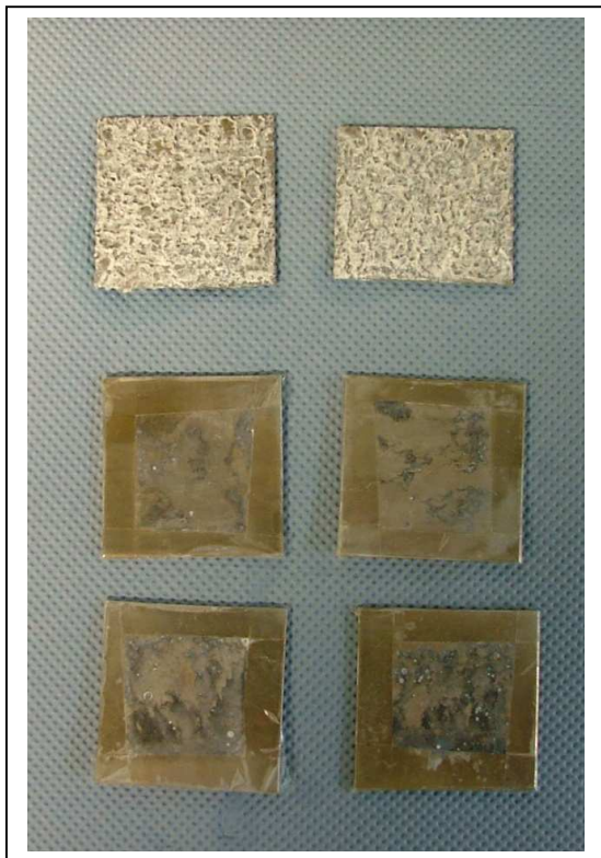
Abbildung 5: Nachbehandlung von chem. polierten AZ31- Proben, nach 24 SS- Test
