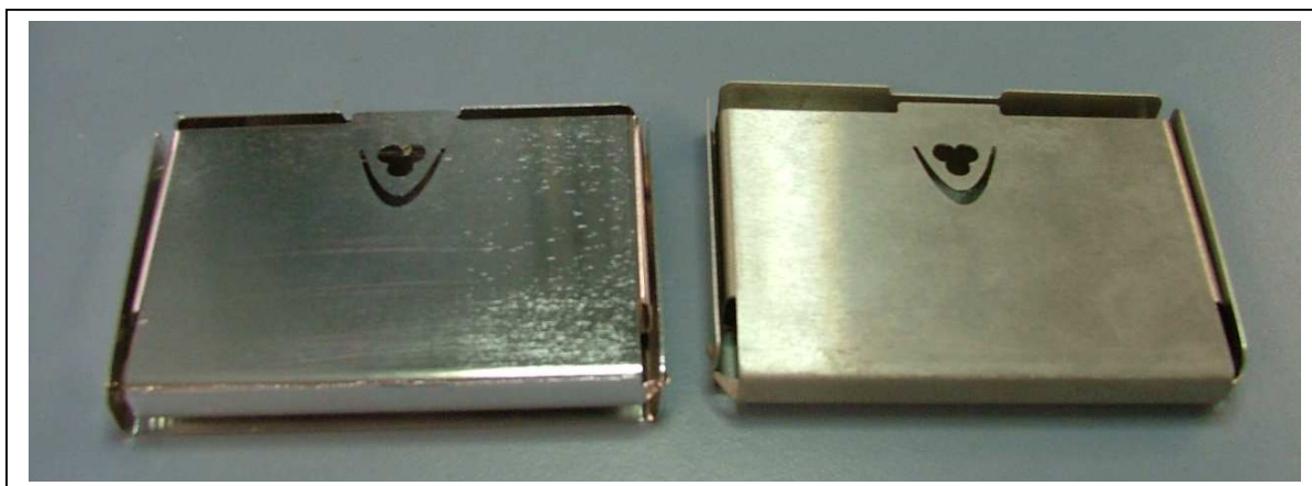
Bild 1: Chemisch polierter (links) und Ausgangszustand eines umgeformten AZ31- Bauteiles
