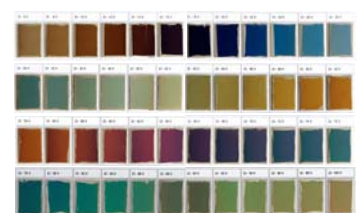
Farbspektrum nach anodischer Oxidation von PVD-Zirkonschichten auf AZ31 (mechanisch poliert)
