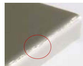
Beispiel AZ31 für chemische Vorbehandlung und Kombination aus chemisch und plasmachemischer Vorbehandlung nach erfolgreicher PVD-Beschichtung und anodischer Oxidation
