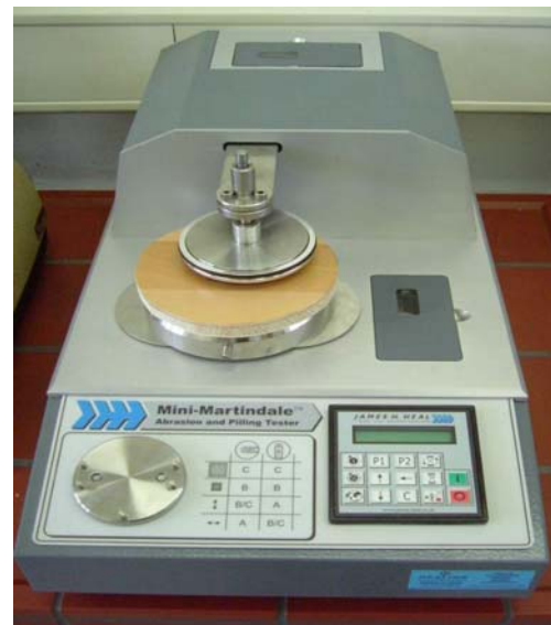
Messung der Mar-Resistance mit dem Martindale-Gerät
