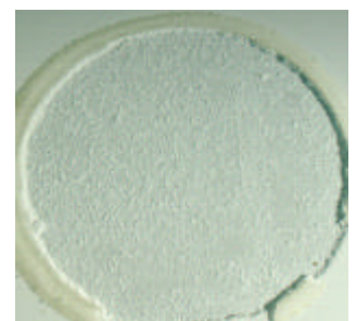
2b: Abreißprüfung Kohäsionsbruch in der Lackierung
