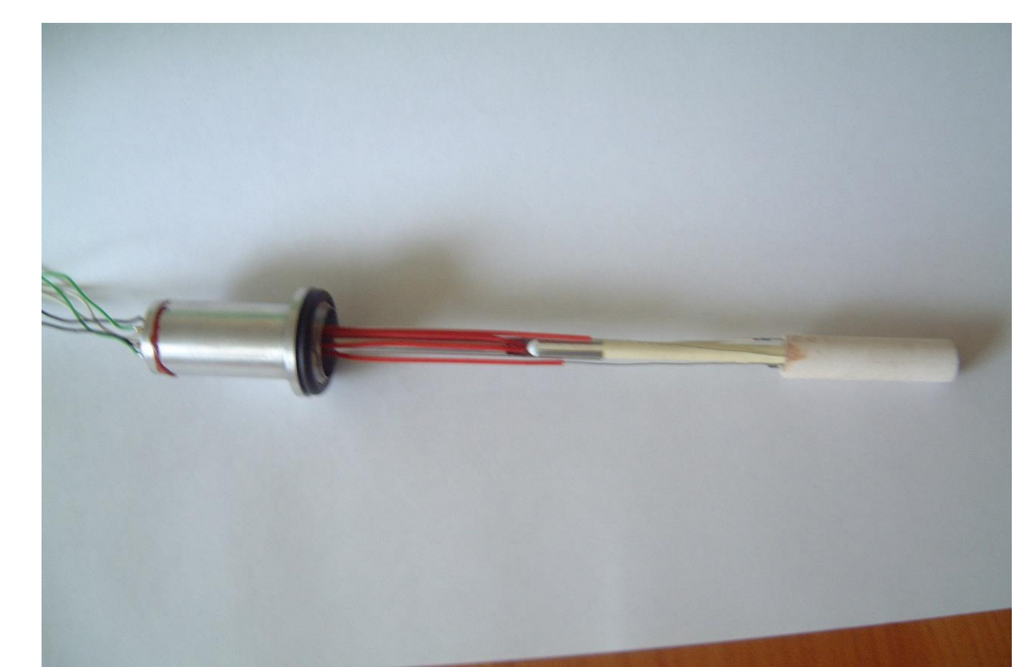
Ansicht der Versuchssonde mit Cu/Cu 2 O-Bezugssystem
